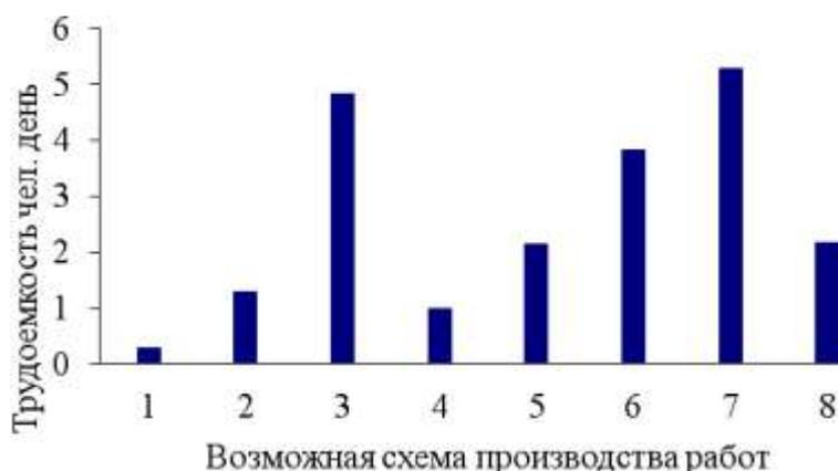
Рисунок 4 - Зависимость трудоемкости производства земляных работ от выбранной схемы
